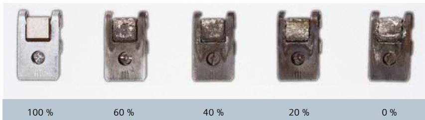
Foto 2.2 Ejemplo de desgaste de los contactos principales de un contactor
