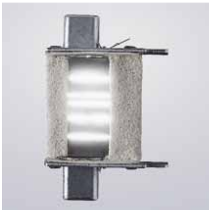
Foto 11.3 Fusible NH en cortocircuito
