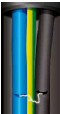
Foto 18.6 Falla de arco en paralelo fase-neutro
