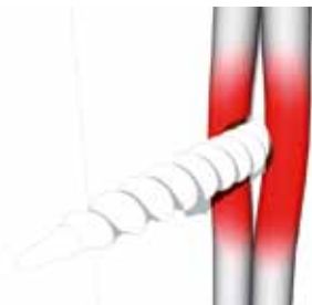
Foto 18.2 Ejemplo de aislación dañada por perforación
