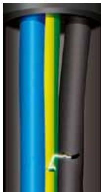
Foto 18.7 Falla de arco en paralelo fase-tierra
