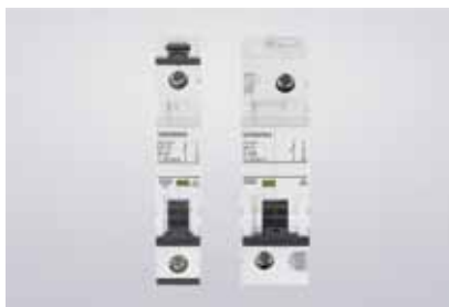
Foto 12.3 Ancho de 18mm por polo hasta los 63A (5SX y 5SY) y de 27mm en 80, 100 y 125A (5SP).
