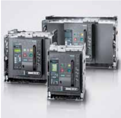
Foto 15.3 Interruptores automáticos ACB, tamaños constructivos. Tamaño I: 630 ... 2000A; Tamaño II: 1250 ... 3200A; Tamaño III: 4000 ... 6300A.
