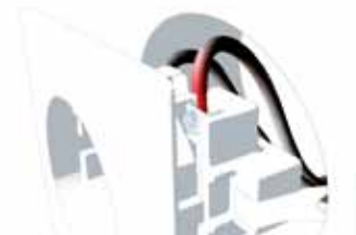
Foto 18.5 Ejemplo de falla de arco por borne flojo
