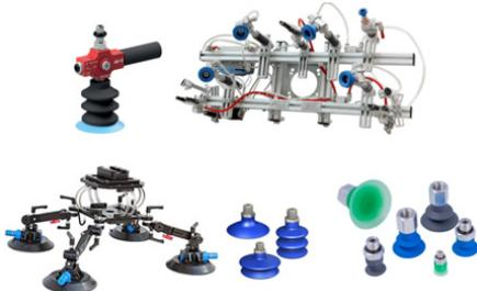
El sistema de vacío por Venturi y la ventosa, constituyen una unidad compacta que es transportada por el robot. Lógicamente, este método de sujeción es sólo aplicable a materiales que permitan la estanqueidad. Ejemplos de manipulación por vacío son superficies planas de plástico, vidrio, papel o metal.
